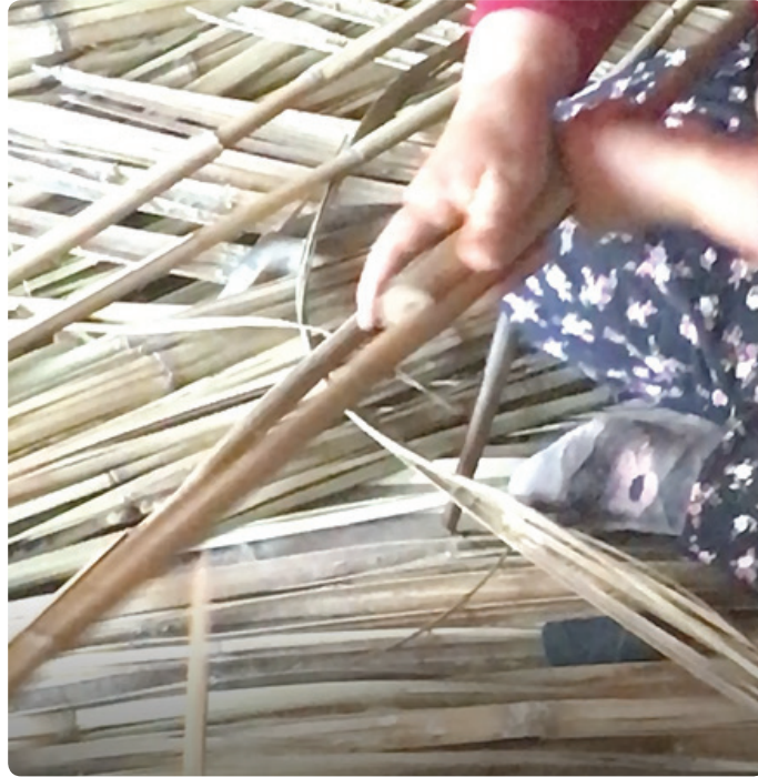
Fotoğraf 56. Yaracak ile kamışların açılması. (Kılıç Karatay, 2017)
