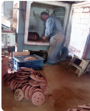
Fotoğraf 72. Fırında pişirme işlemi. (Kılıç Karatay, 2017)
