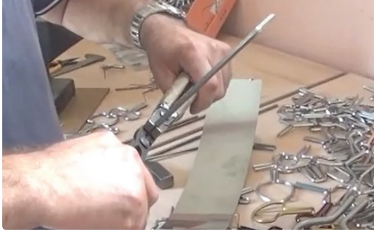
Fotoğraf 220. Demir çubuğun iki ucunun içeri katlanması (Kılıç Karatay, 2017)
