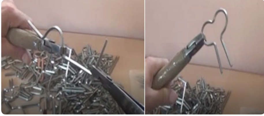
Fotoğraf 223. Çubuğun diğer ucuda bükülerek kalb şeklini alması(Kılıç Karatay, 2017)
