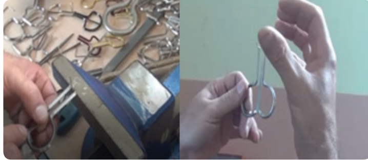
Fotoğraf 226.Çubuğun orta kısmına Dil telinin yerleştirilmesi(Kılıç Karatay, 2017)
