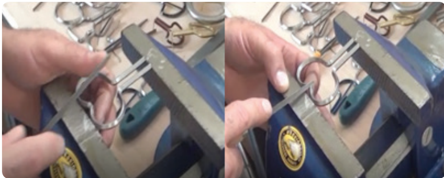
Fotoğraf 225.Çubuğun orta kısmında oyma işlemi(Kılıç Karatay, 2017)
