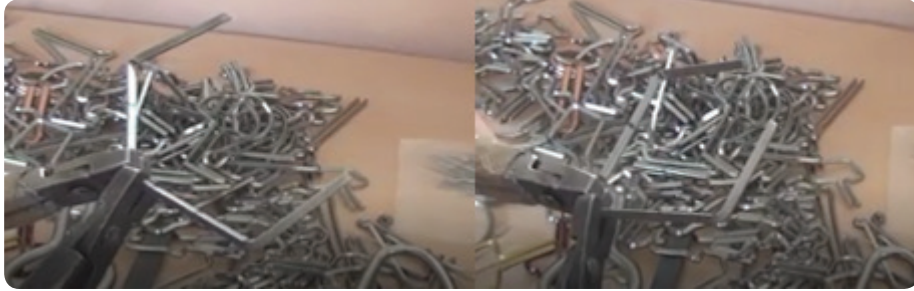
Fotoğraf 221. Demir çubuğun iki ucunun ortadan içeri katlanması (Kılıç Karatay, 2017)
