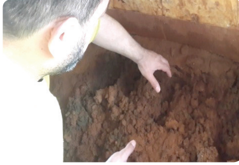
Fotoğraf 66. Toprakların karıştırılması. (Kılıç Karatay, 2017)
